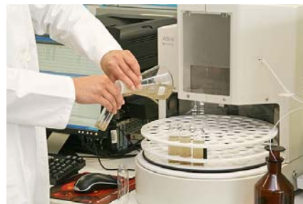
Abbildung 3: Umfüllen in ein Autosampler-Probengefäß und die Messung einfach gestartet
