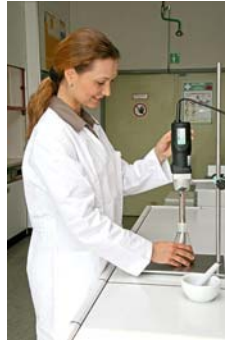
Abbildung 2: Die Suspension wird mit einem Dispergiergerät zerkleinert und homogenisiert
