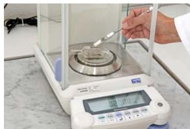
Abbildung 1: Erster Schritt: Die vorzerkleinerte Feststoffprobe wird eingewogen
